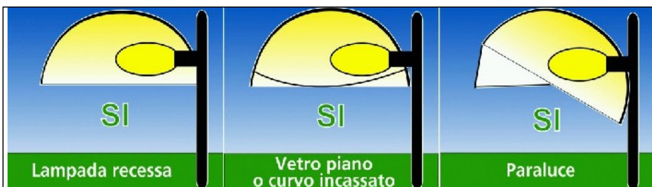
Figura 5.2 – Tipologie di apparecchi conformi alla legge n. 17/2000 (cortesia: CieloBuio)
