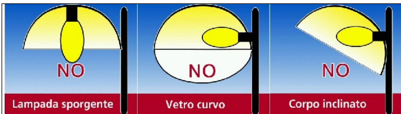
Figura 5.1 – Tipologie di apparecchi non ammessi (cortesia: CieloBuio)
